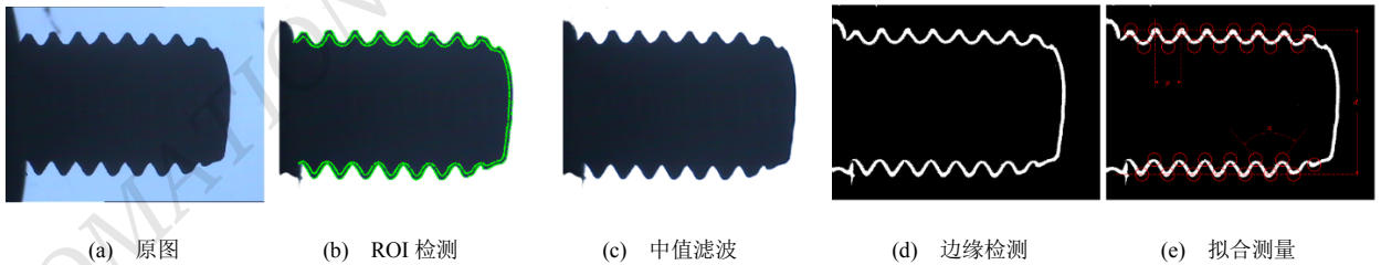
图 5 拟合测量链路各步骤的处理结果
