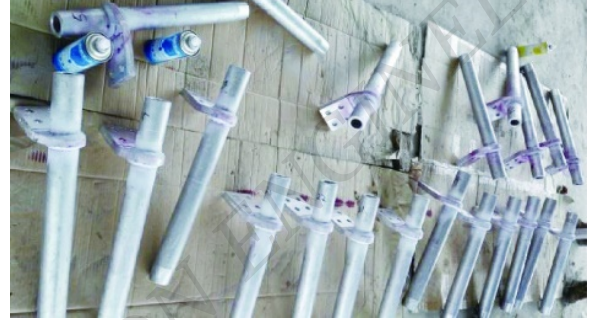
(b) 施涂显像剂后的耐张线夹
