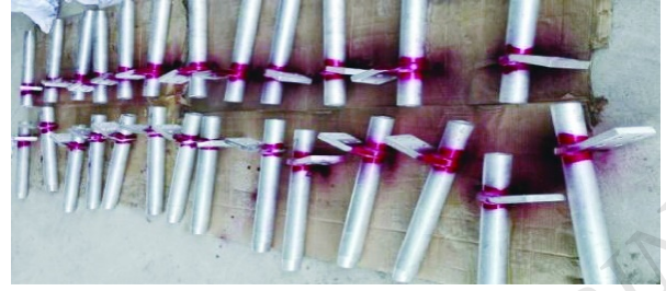
(a) 施涂渗透液后的耐张线夹
