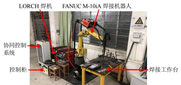
图 2 工业机器人铝合金双脉冲 MIG 焊试验平台
