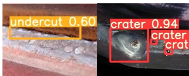
图7 焊缝表面缺陷检测效果图
