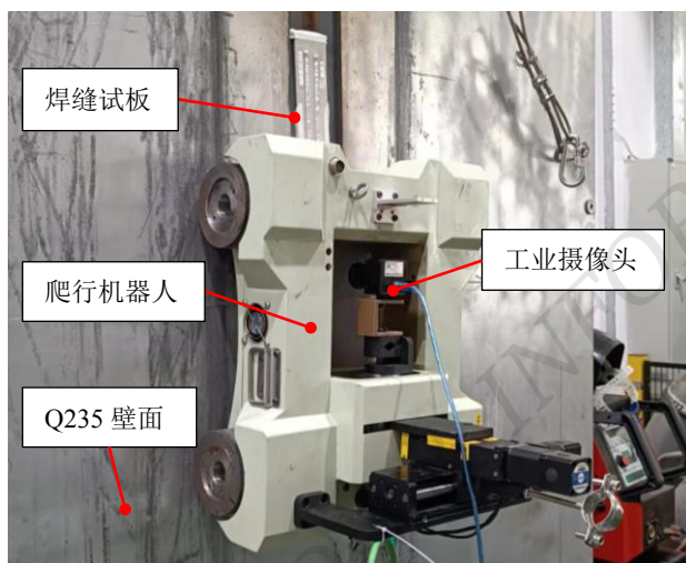
图 8 轮式磁吸附爬行机器人在 Q235 钢铁壁面运动
