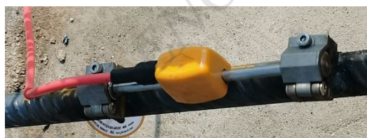
(b) 焊接冷却后，拆下模管，装上应变计
