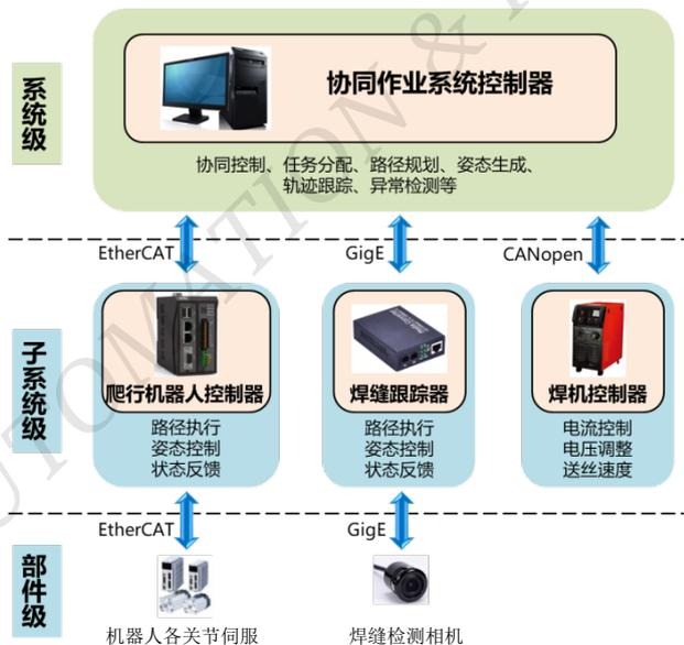
图 2 9 自由度爬行焊接机器人控制系统总体框架
