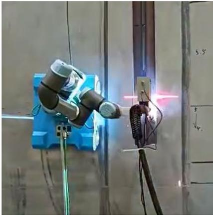
图 10 爬行焊接实验实物图
