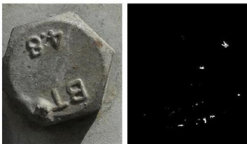
图 11 正常的螺栓的检测图
