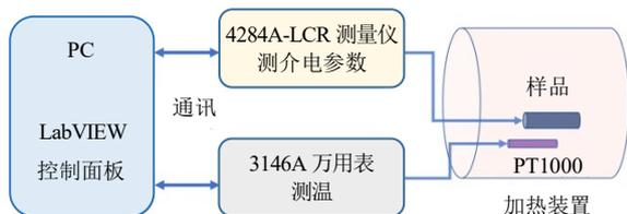
图 5 介电温谱测量系统结构图
