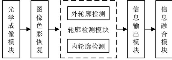
图 1 无人船障碍物水下图像边缘检测方法框图
